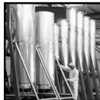
Batterie de percolateurs en continu
